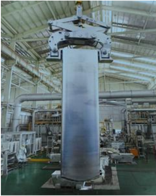
Jumbo size slab (Size :1620mm×520mm×6000mm)
