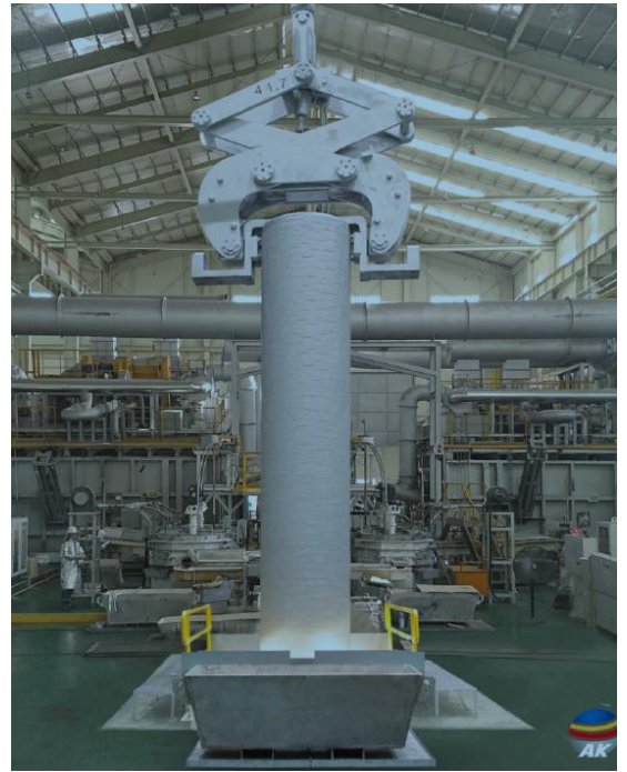
Jumbo size billet(size : Ø 1060mm×6000mm)
